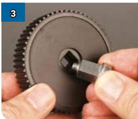
3 Поместите квадратную в сечении часть оси в отверстие в колесе с той стороны, где отсутствуют отверстия для саморезов.
