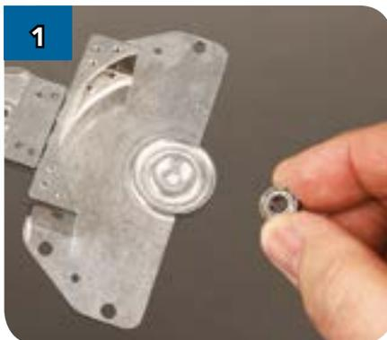
1 Возьмите подшипник, который вы получили с выпуском 26. Его диаметр равен диаметру гнезда в детали (LFR-10).
